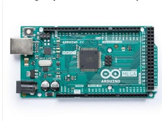
**Fig.(ii) Arduino MEGA**
