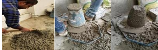
Fig.4.1. slump cone test
